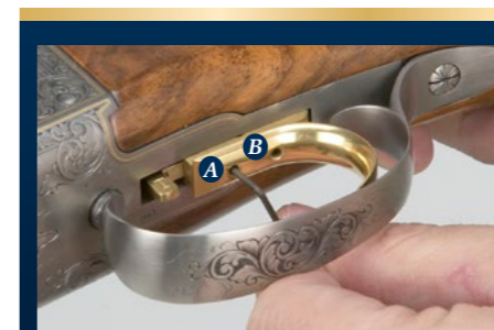
A: Schraube zum Feststellen der Laufumschaltung
